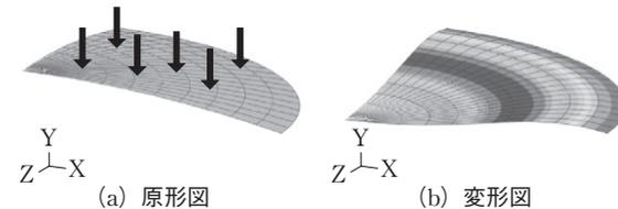
図 1.6 浅いアーチの飛び移り座屈変形
