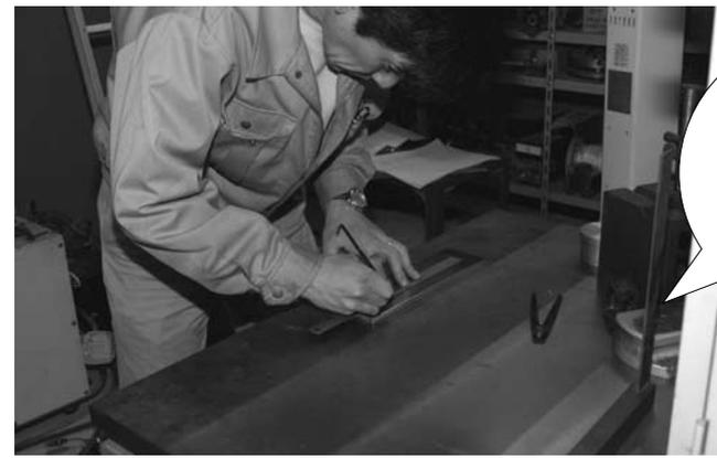
その後の加工の目安をつけるために、部品の表面に線を引く作業です。
