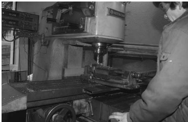
図1.1 フライス盤による端面加工
