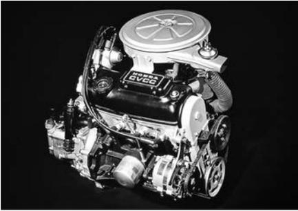
マスクー法の厳しい規制を後処理なしで真っ先にクリアしたホンダのCVCCエンジン。複合渦流調整燃焼方式の頭文字をとってその名が付けられた。
