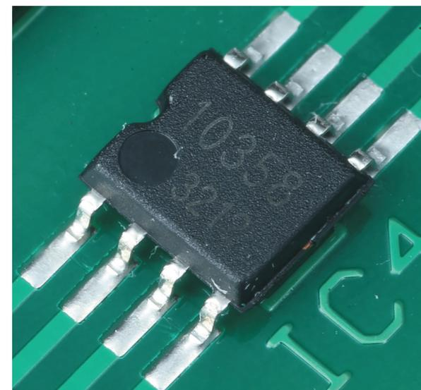
図 1.1.2 はんだ付け接合部の拡大写真
