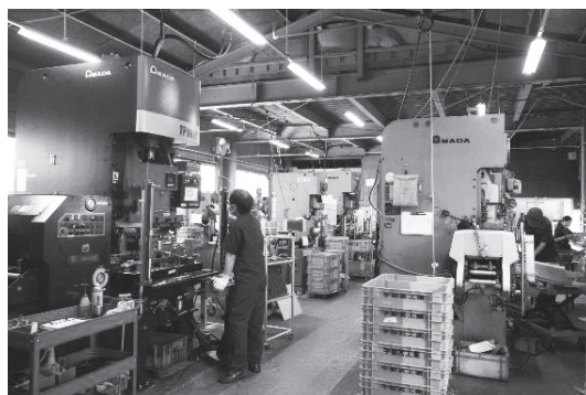
写真2 沼製作所の加工現場。60t プレスを中心にした設備構成で、小物の建築部品などの少量・量産のプレス加工を手がけている
